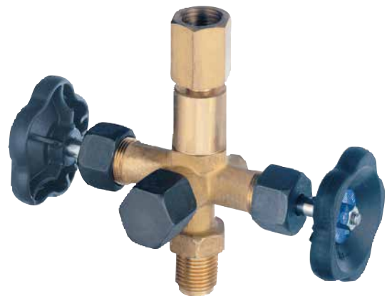
Zawór odcinający z izolowanym przyłączem testowym wg DIN 16 272, nakrętka/ zew. G 1/2, ze złączem testowym M 20 x 1,5, PN 400
